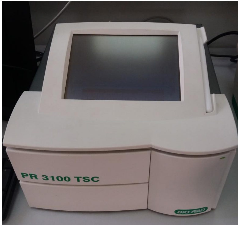
Slika 5. Spektrofotometar korišten za mjerenje intenziteta obojenja (fotografirala autorica)
