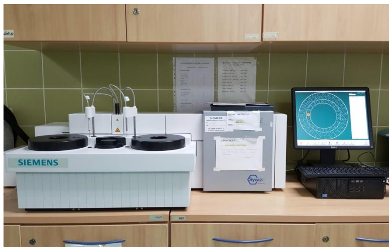
Slika 9. Siemens Viva-E kemijski analizator (slika autorice)
