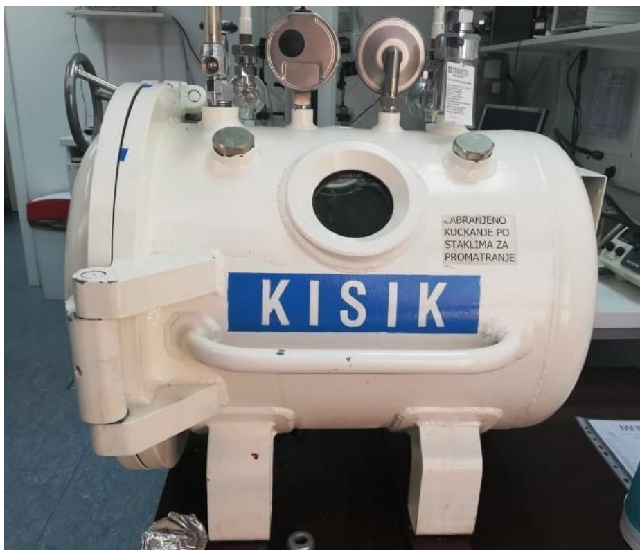
Slika 1. Hiperbarična komora za eksperimentalne životinje (Laboratorij za fiziologiju cirkulacije, Katedre za fiziologiju i imunologiju Medicinskog fakulteta u Osijeku).
