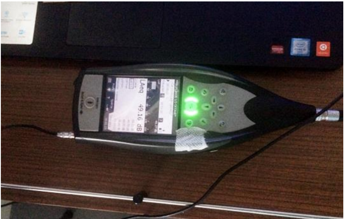
Slika 4.2. Zvukomjer korišten u istraživanju - Bruel&Kjaer, Danska, model 2250L
