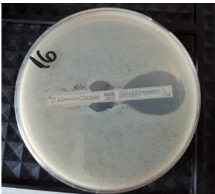
Slika 5.8. E-test ESBL na M-H agaru
