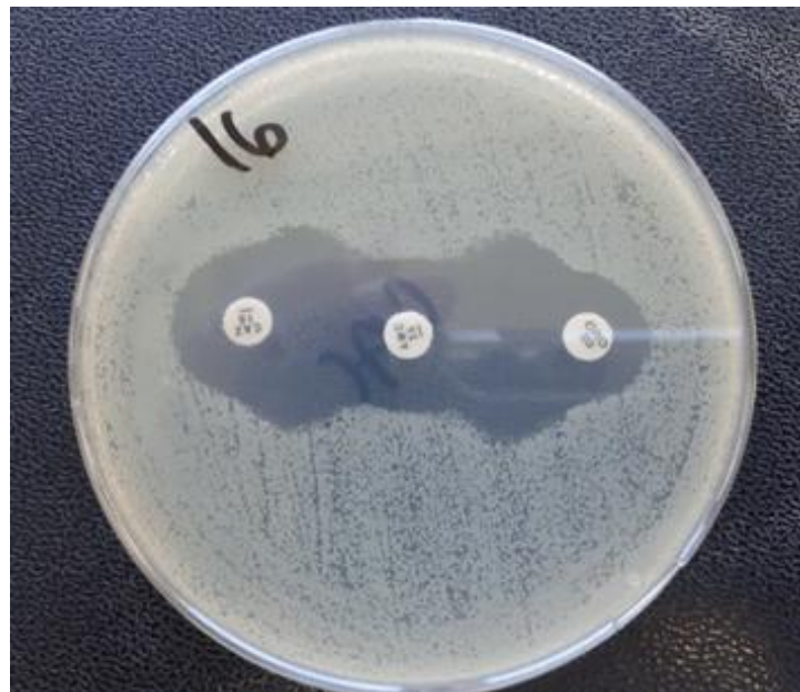
Slika 5.6. Metoda dvostrukoga diska (DDST) na M-H agaru
