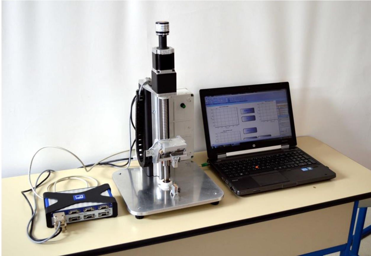
Slika 4.11. Uređaj za vlačni pokus, mjerno pojačalo HBM Quantum MX 840 te računalo sa sučeljem programa Catman Easy
