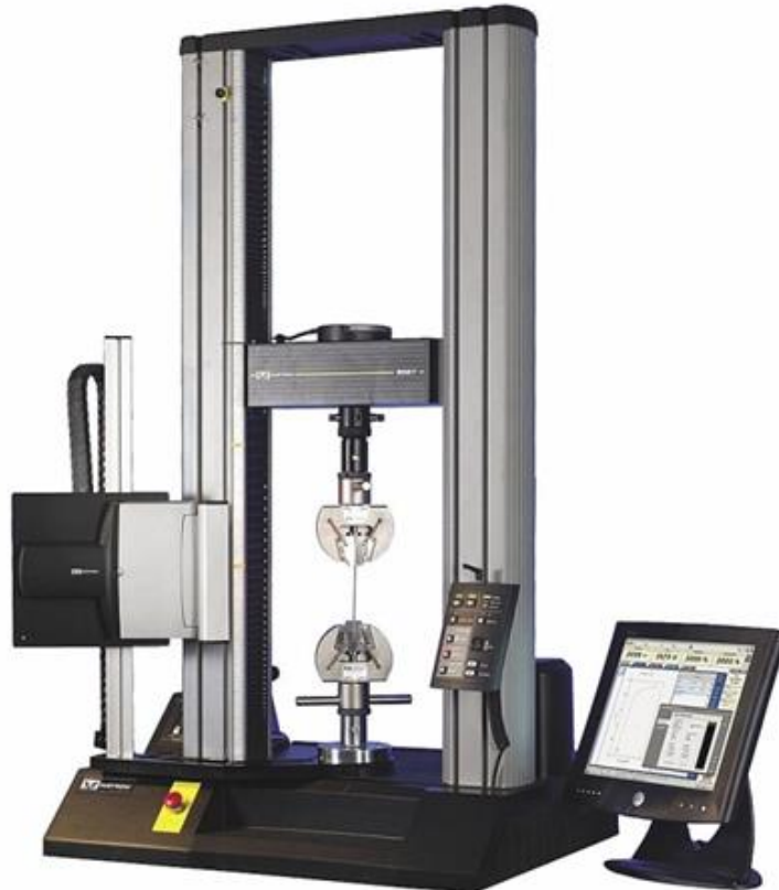
Slika 4.6. Tipičan elektromehanički uređaj za vlačni pokus (30)
