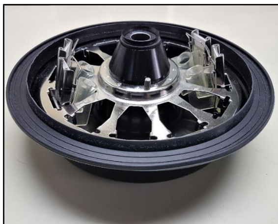
Slika 3. Smještaj nosača sa komoricama u citocentrifugi
