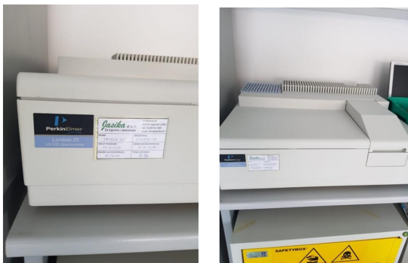
Slika 5. Perkin Elmer Lambda 25 UV/VIS spektrofotometar. (izradio autor)
