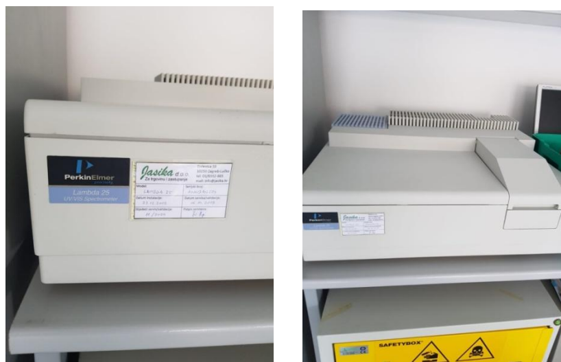
Slika 5. Perkin Elmer Lambda 25 UV/VIS spektrofotometar. (izradio autor)
