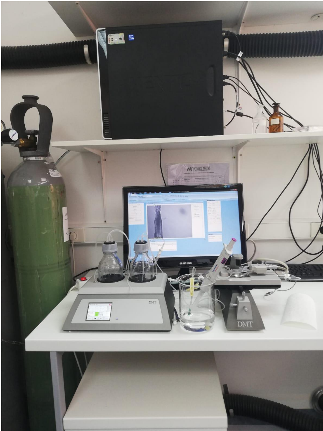
Slika 2. Sustav tlačnog miografa – DMT (izvor: original autorice rada)
