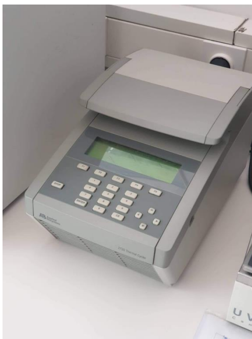
Slika 4. Uređaj za PCR 2720 Thermal Cycler, Applied Biosystems korišten u istraživanju (fotografija snimljena u Laboratoriju za medicinsku genetiku Medicinskog fakulteta u Osijeku, kolovoz 2019.)
