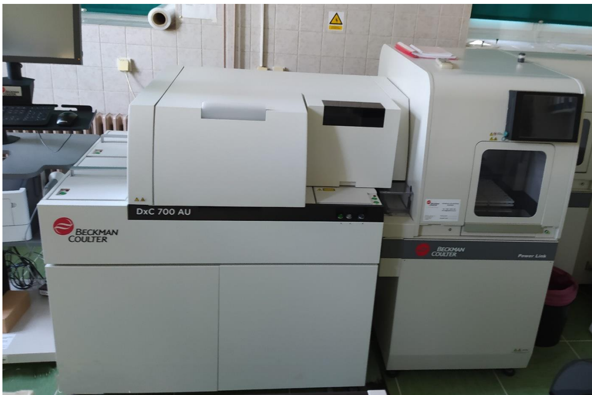
Slika 2. Biokemijski analizator tvrtke Beckman Coulter , KBC Osijek
