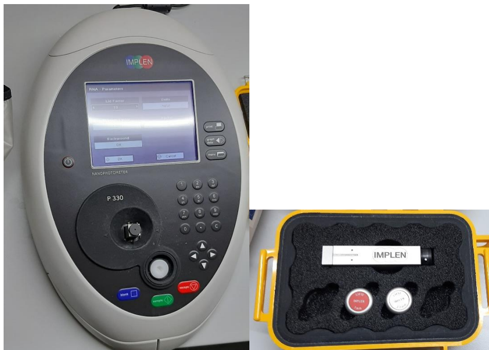
Slika 3. Implen spektrofotometar P330 (izvor: original autorice rada)
