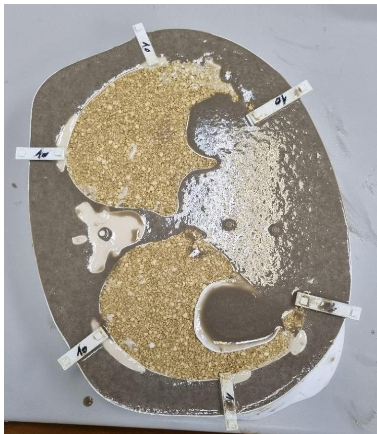
**Slika 4.18.** Jedan od izlivenih kalupa ostavljen na ravnoj površini i na sobnoj temperaturi 24 – 48 h radi potpune polimerizacije. Na površini uz rub kalupa mogu vidjeti se nakupljeni mjeđurići zraka koje je moguće probušiti prilikom procesa polimerizacije ili izravnati površinu njenim brušenjem nakon polimerizacije. Izvor: autor rada.
