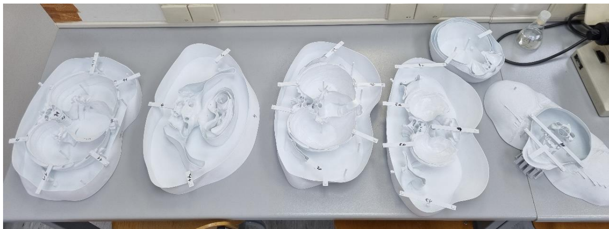
Slika 4.13. Postavljanje sastavljenih kalupa na ravnu i čvrstu podlogu u Praktikum Katedre za biofiziku Medicinskog fakulteta Osijek. Izvor: autor rada.
