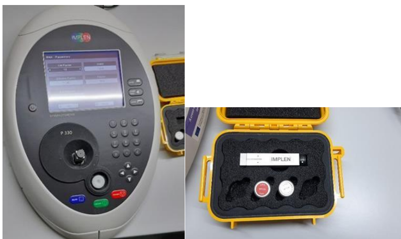
Slika 5. Implen nanofotometar P330 UV/VIS (Izvor: fotografirala autorica rada)
