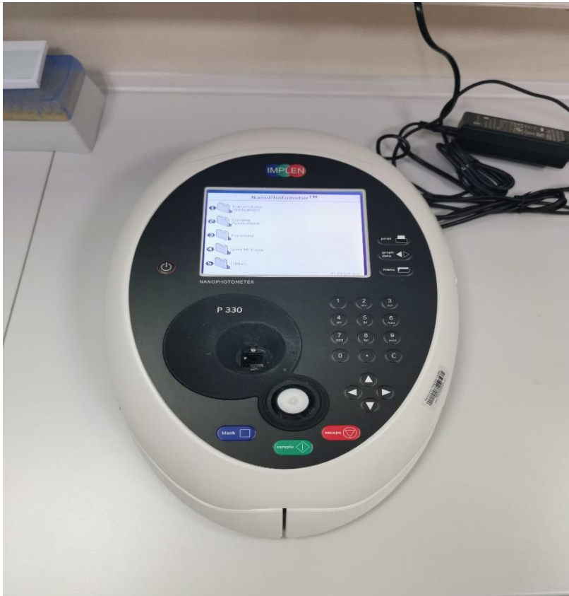
Slika 1. Uređaj za mjerenje čistoće koncentracije RNA - spektrofotometar IMPLEN (Izvor: fotografirala autorica rada)
