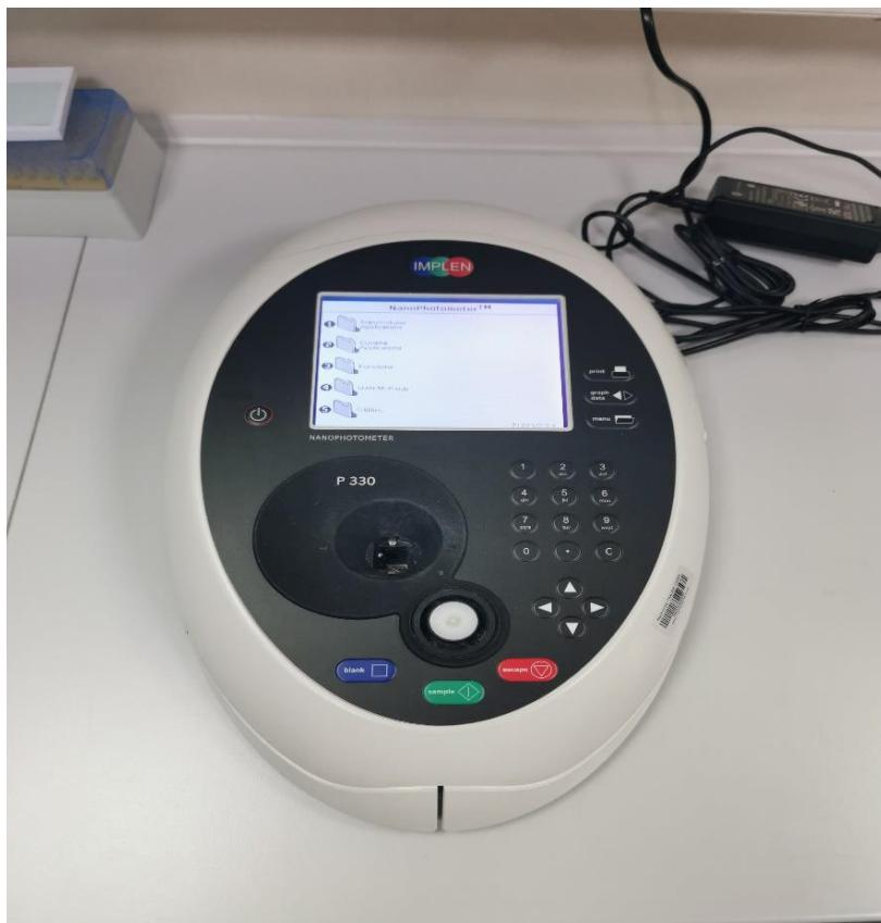
**Slika 1.** Uređaj za mjerjenje čistoće koncentracije RNA - spektrofotometar IMPLEN (Izvor: fotografirala autorica rada)
