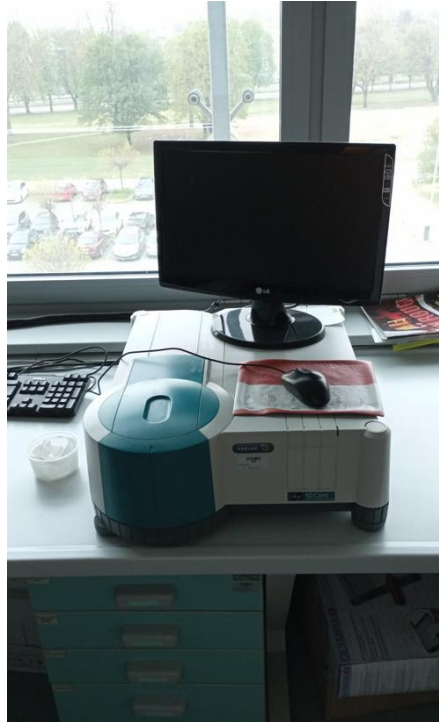
Slika 7. Varian Cary 50 UV-Vis spektrofotometar (Agilent Technologies, Inc., Santa Clara, CA, USA) (izvor: original autora rada)
