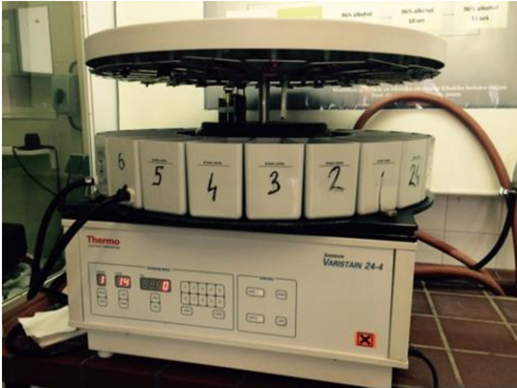
Slika 6. Aparat za bojanje po Papanicolau (iz arhive Kliničkog zavoda za kliničku citologiju KBC-a Osijek)
