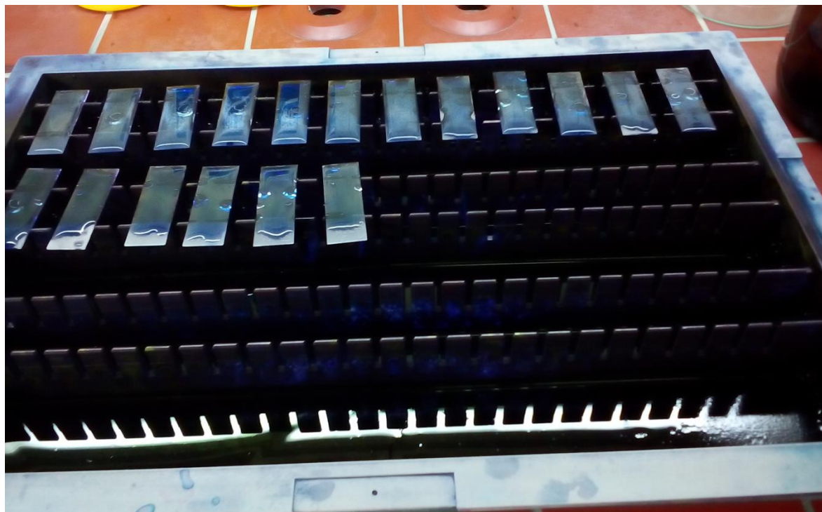
Slika 5. Postupak bojenja G-W preprata na stalku za bojenje
