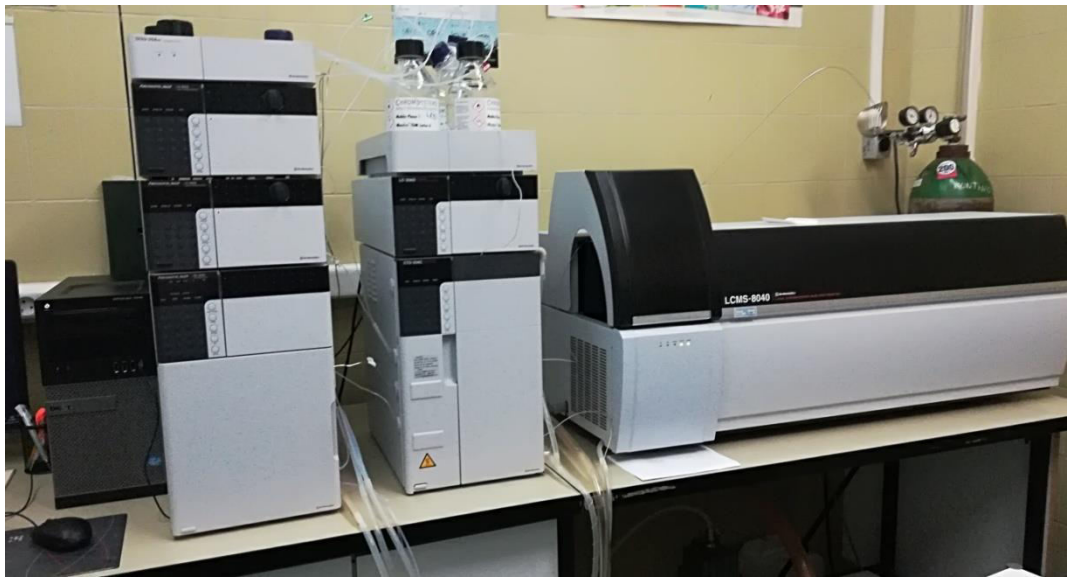
Slika 6: Uređaj LC-MS/MS-8040 Shimadzu
