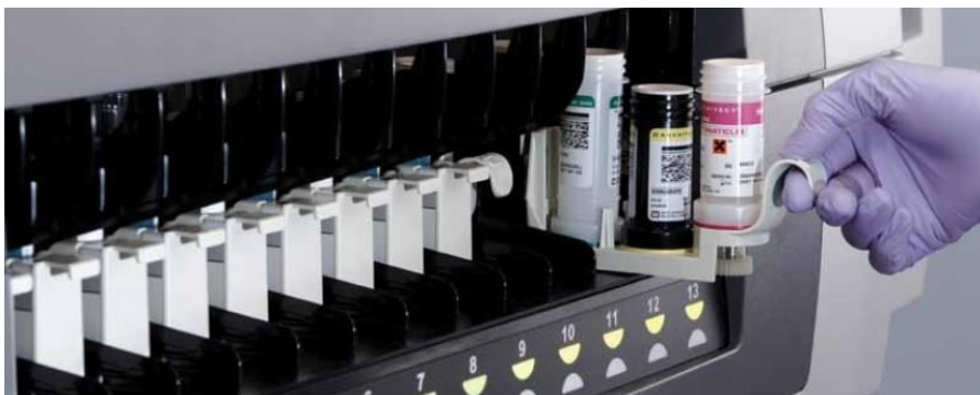
Slika 8: Ulaganje reagensa u uređaj Arcihtect i1000SR
