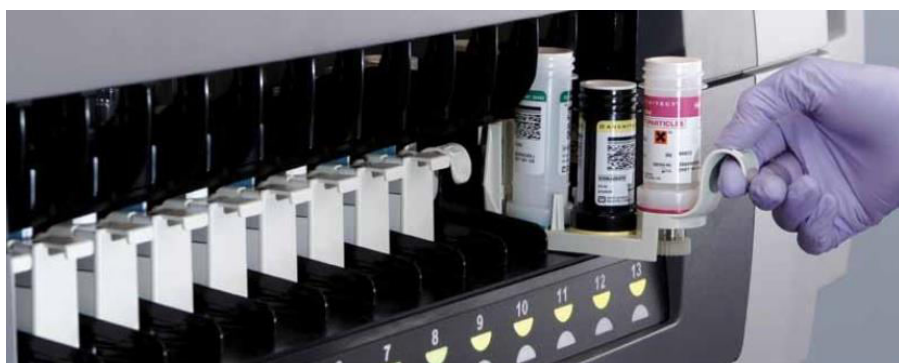
Slika 8: Ulaganje reagensa u uredaj Arcihtect i1000SR
