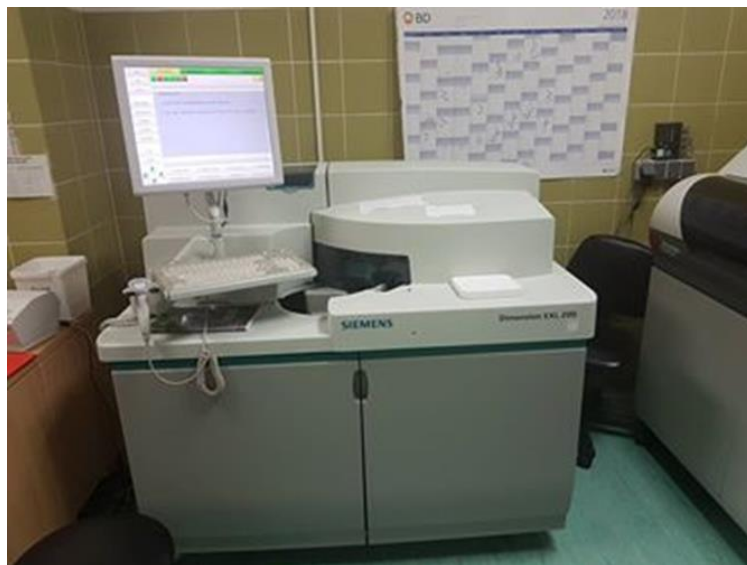
Slika 1. Uređaj za mjerenje koncentracije mioglobina i cTnI-ja
