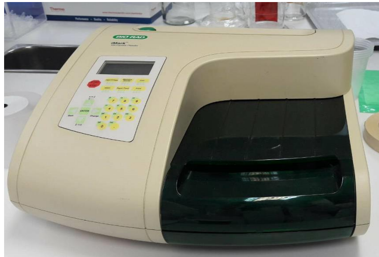
Slika 1. Čitač mikrotitarskih pločica – BioRad (izvor: original autorice rada)
