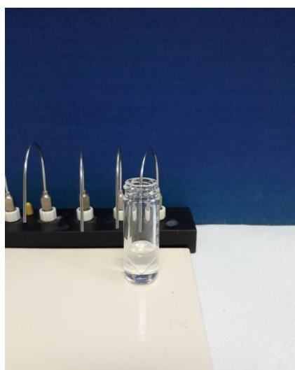
Slika 8: Uparavanje organskoga dijela nakon ekstrakcije (fotografija autorice)
