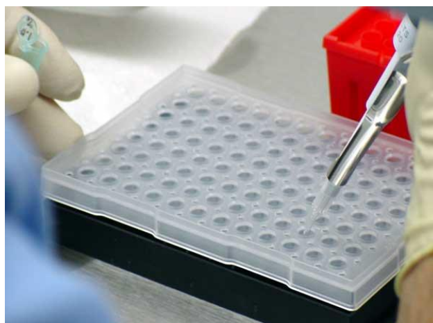
Slika 7. Postavljanje reakcije lančane reakcije polimeraze u stvarnom vremenu
