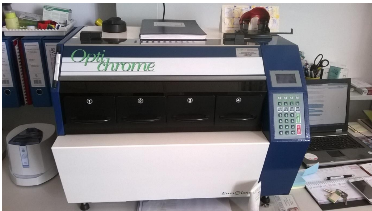
Slika 3. Raspršivač metafaza (OptiChrome Euroclone)
