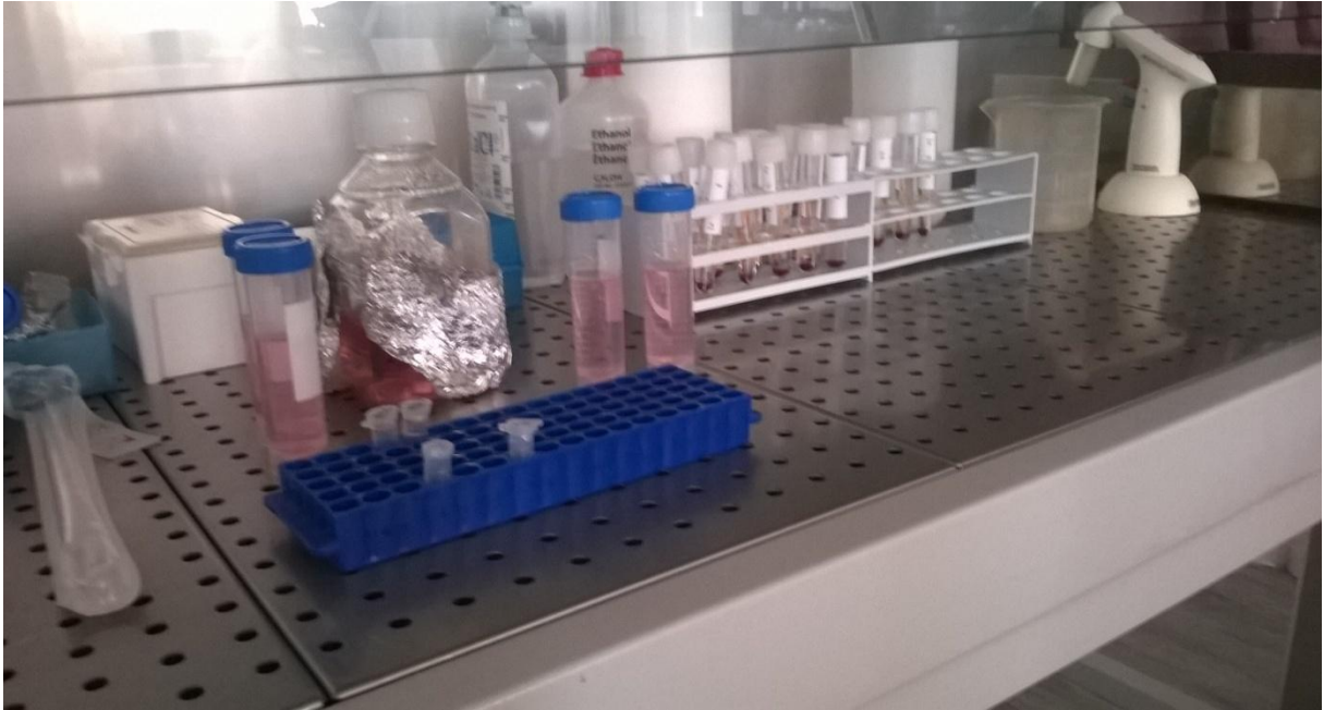
Slika 1. Sterilni kabinet s vertikalnim strujanjem zraka (Uniflow aura-VF72 laminar)
