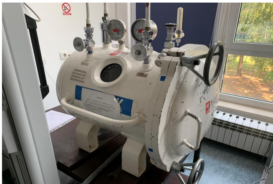
Slika 2. Hiperbarična komora (izvor: original autorice rada)
