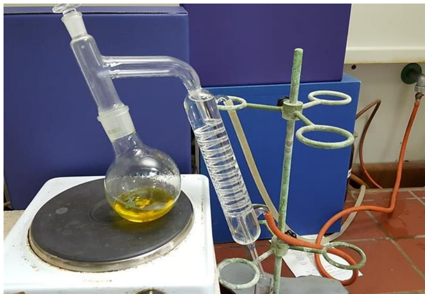
Slika 7. Destilacija uzorka (slika autorice)
