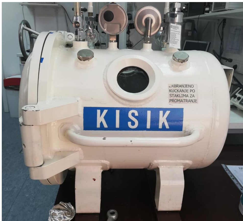
Slika 1. Hiperbarična komora za eksperimentalne životinje (Laboratorij za fiziologiju cirkulacije, Katedre za fiziologiju i imunologiju Medicinskog fakulteta u Osijeku).
