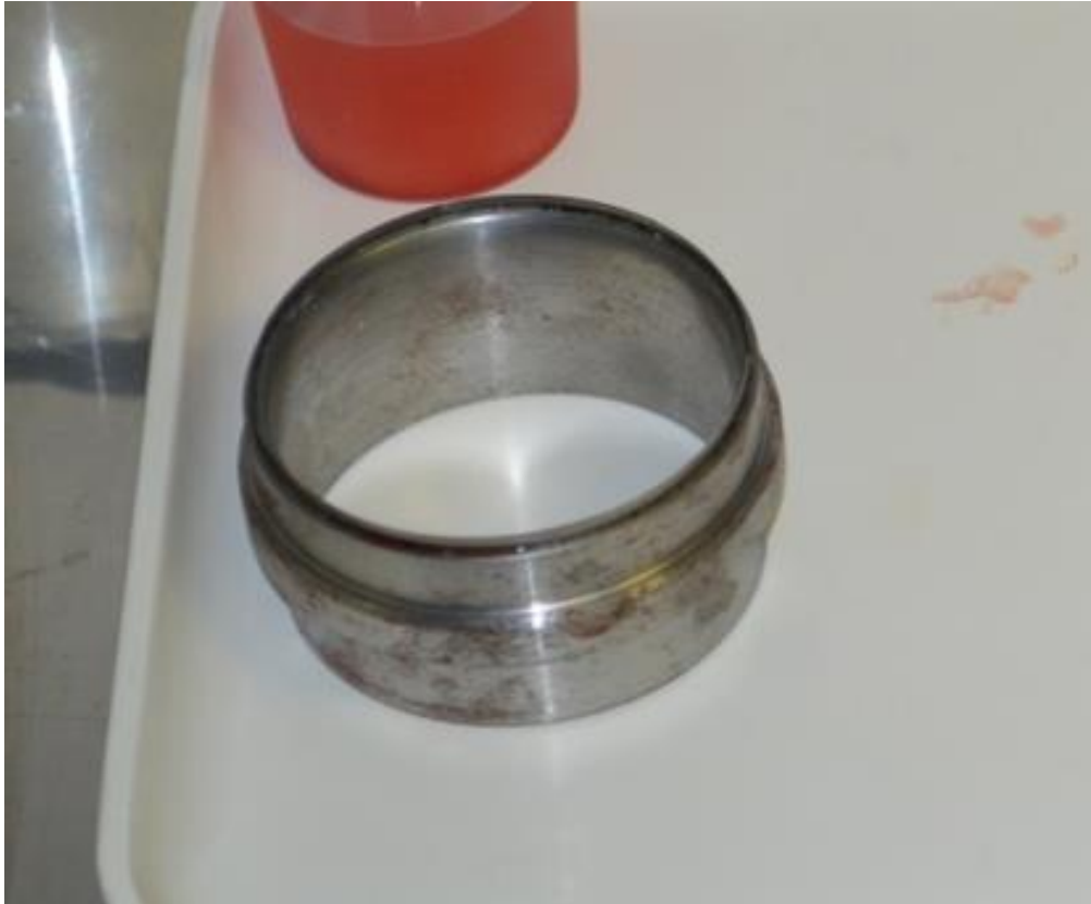
Slika 4.5. Nož za izrezivanje uzoraka za dvoosna ispitivanja
