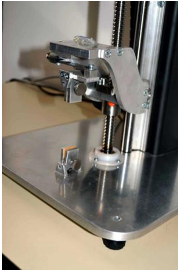
Slika 4.10. Stezne čeljusti uređaja za vlačni pokus pri ispitivanju plodovih ovoja
