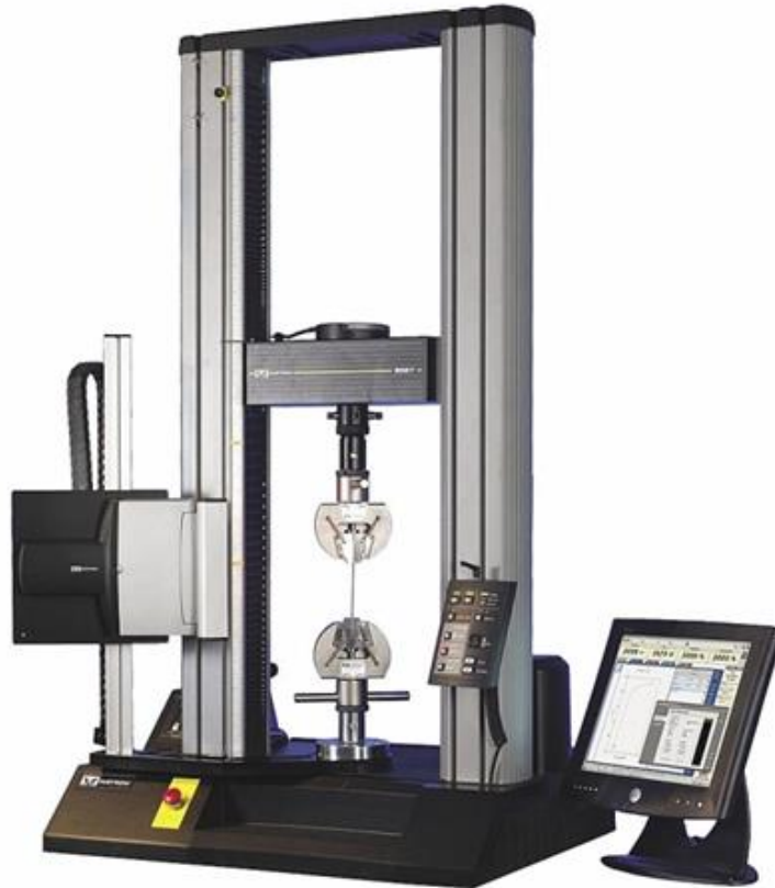
Slika 4.6. Tipičan elektromehanički uređaj za vlačni pokus (30)
