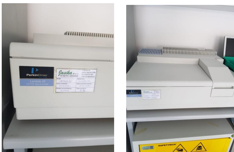
Slika 5. Perkin Elmer Lambda 25 UV/VIS spektrofotometar. (izradio autor)
