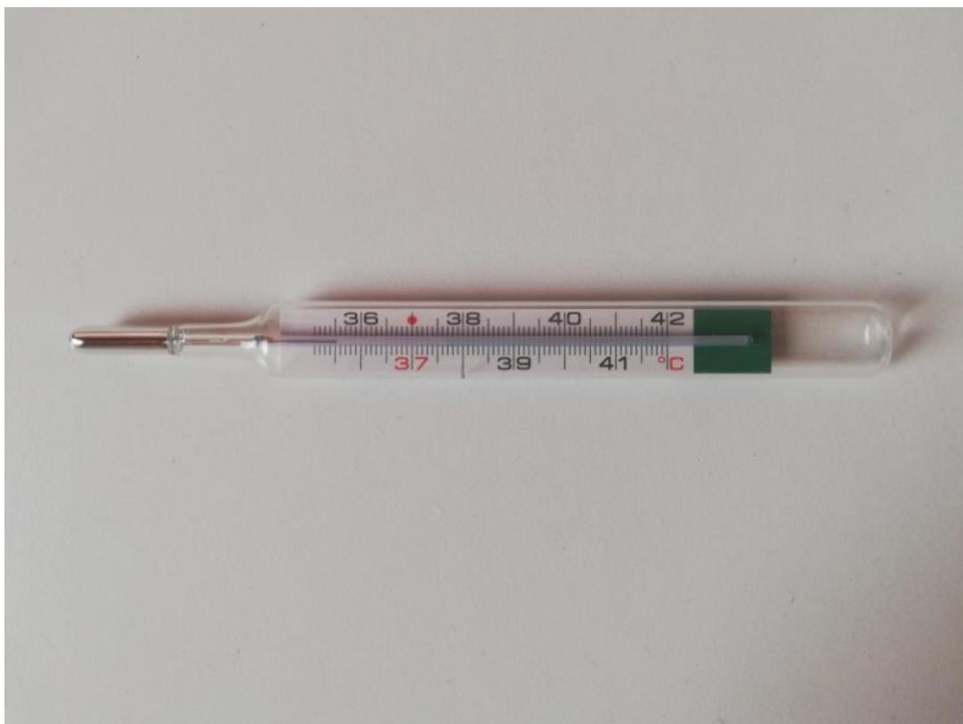
Slika 3. Galijev termometar
