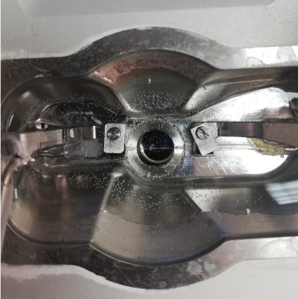
Slika 3. Komorica sa žilom (izvor: original autorice rada)
