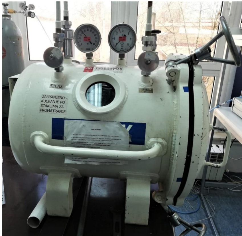
Slika 1. Rekompresijska komora za eksperimente – Đuro Đaković (izvor: original autorice rada)
