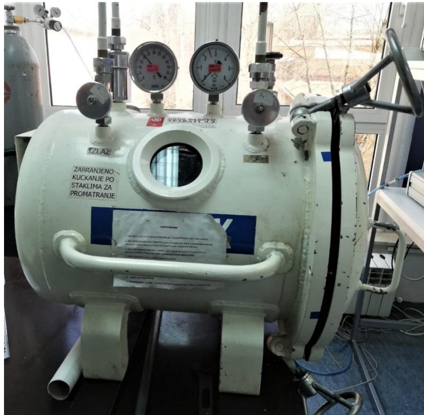
Slika 1. Rekompresijska komora za eksperimente – Đuro Đaković (izvor: original autorice rada)
