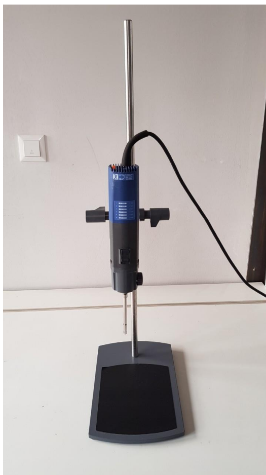
Slika 4. Mehanički homogenizator. (Izvor slike: Slikano u laboratoriju za fiziologiju i imunologiju, Katedra za fiziologiju i imunologiju Medicinskog fakulteta u Osijeku)
