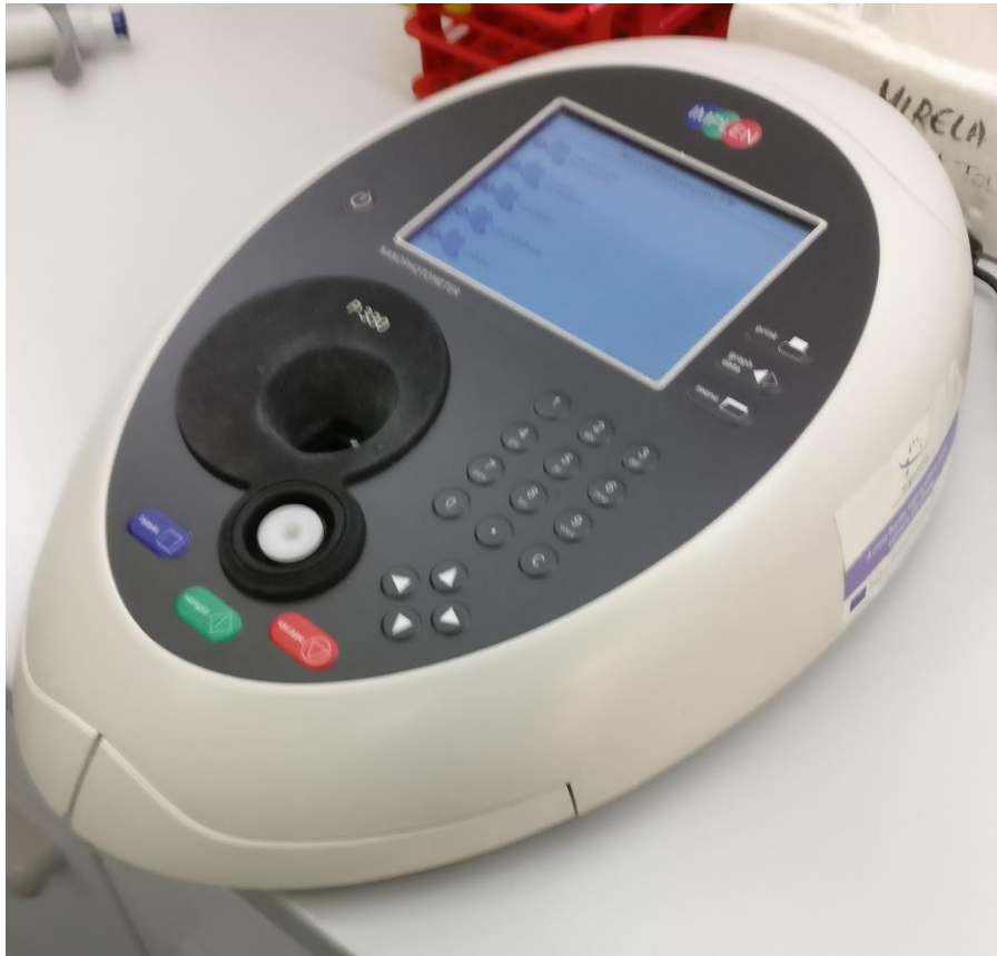
Slika 5. Nanofotometar P330 UV/VIS, IMPLEN. (Izvor slike: Slikano u laboratoriju za fiziologiju i imunologiju, Katedra za fiziologiju i imunologiju Medicinskog fakulteta u Osijeku)
