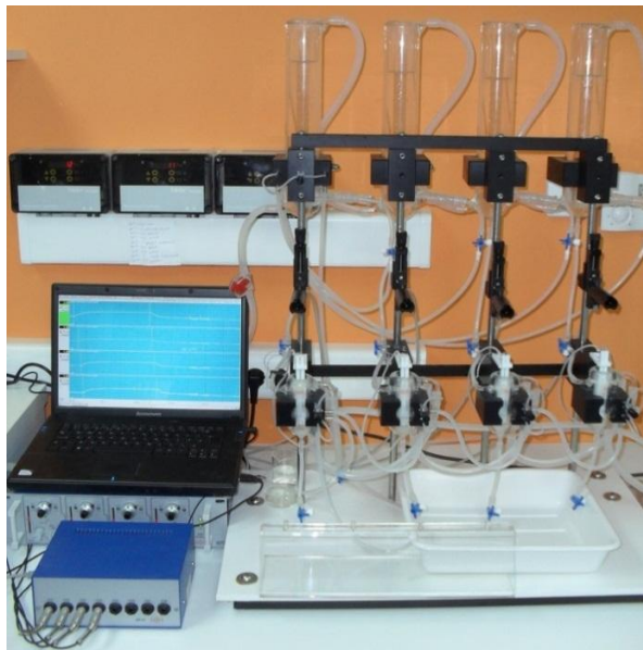
Slika 1. Sustav za izolirane organe
