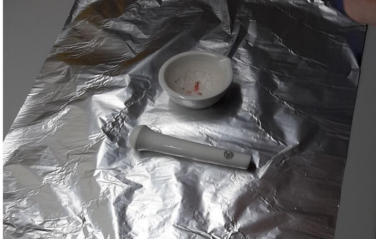
Slika 2. Homogenizacija uzorka u tarioniku (izvor: original autorice rada)
