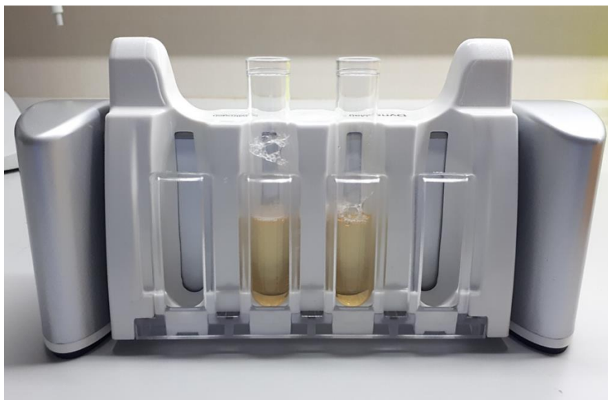
Slika 3. Odvajanje Dynabeadsa iz kulture na magnetu Dynamag 5
