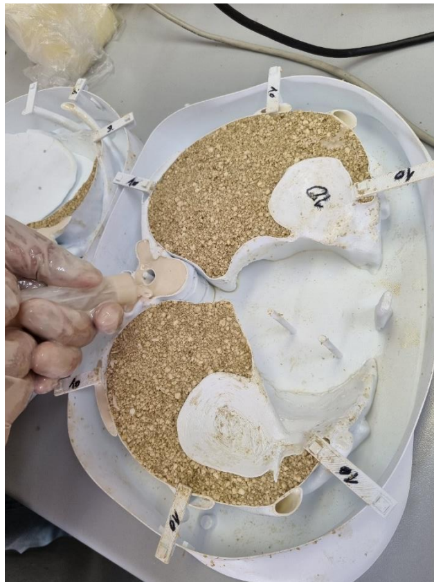
Slika 4.16. Ubrizgavanje smjese BTS u uže dijelove kalupa pomoću šprica. Izvor: autor rada.
