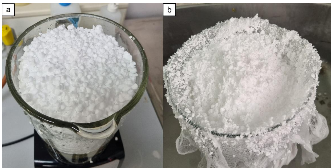
Slika 4.14. a. veličina polistirenskih kuglica prije i b. nakon usitnjavanja u kuhinjskom blenderu. Izvor: autor rada.
