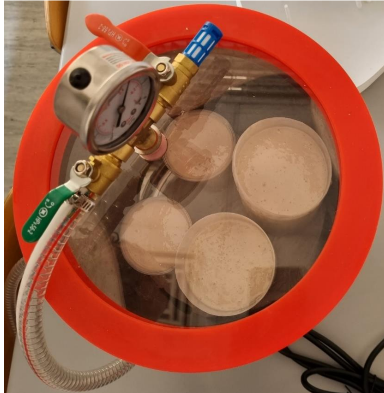
Slika 4.15. Posude s BTS stavljene u vakuumsku komoru radi evakuacije mjehurića nastalih za vrijeme procesa miješanja komponenti smjese. Na površini se može vidjeti nakupljanje mjehurića plina iz smjese. Izvor: autor rada.
