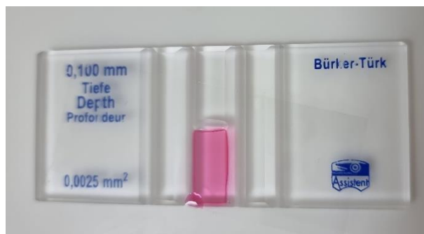
Slika 2. Komorica po Bürker-Türku (izvor: original autorice rada)
