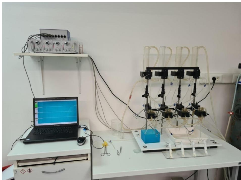
**Slika 6.** Sustav tkivnih kupelji za izolirane organe (Isolated Organ Bath System)
