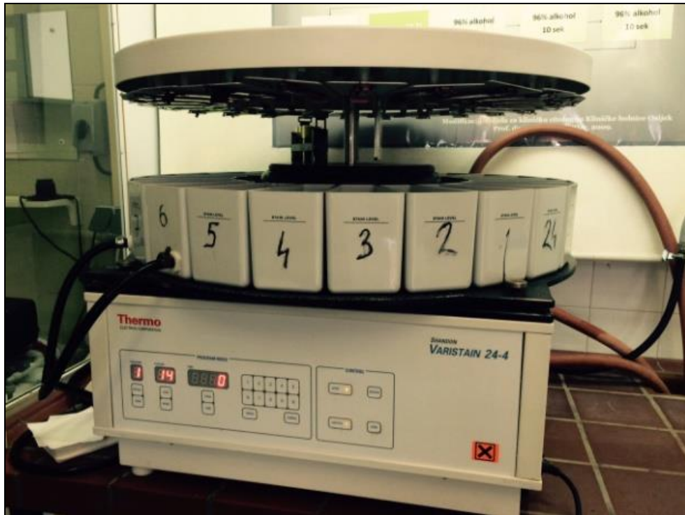
Slika 13. Aparat za bojanje po Papanicolau (iz fundusa Kliničkog zavoda za Kliničku citologiju KBC-a Osijek)
