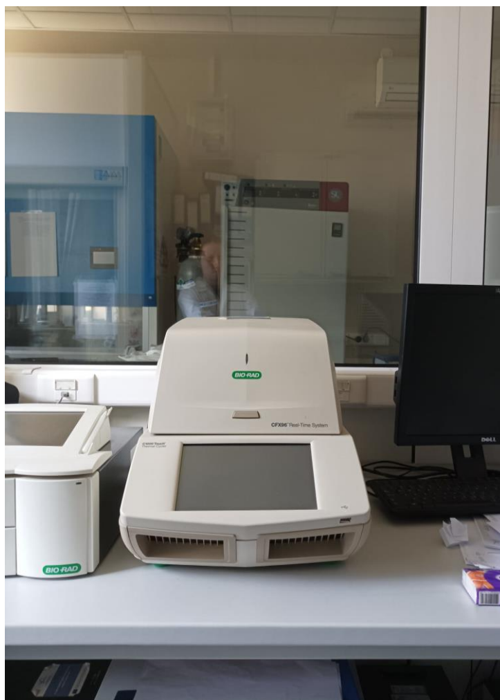
Slika 1: PCR uređaj (izvor: original autorice rada)
