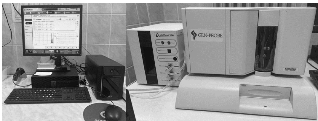
Slika 4.2. Analiza serumske razine Gal-9 i PTX3 na uređaju Luminex 200 (izvor slike: izradila autorica)
