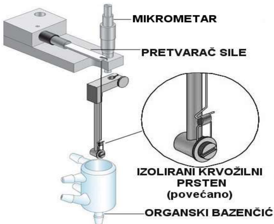
Slika 4.2. Shema sustava za izolirane aortalne prstene (145).
