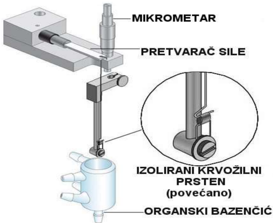
Slika 4.2. Shema sustava za izolirane aortalne prstene (145).
