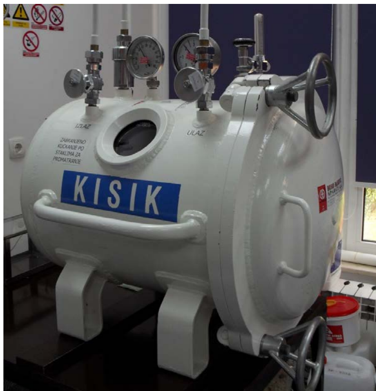
Slika 4.1. Hiperbarična komora za eksperimentalne životinje. Atestirani mjerni instrumenti omogućuju precizno upravljanje.
