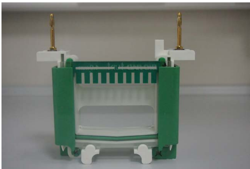
Slika 4.7. Pripremanje gela za SDS-PAGE
