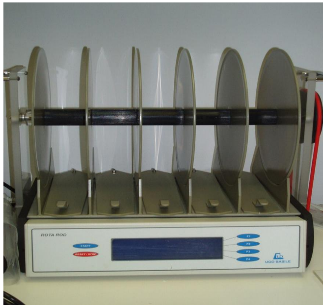
Slika 4.5. Uređaj Rota-Rod 47600 za mjerenje održavanja na rotirajućoj osovini
