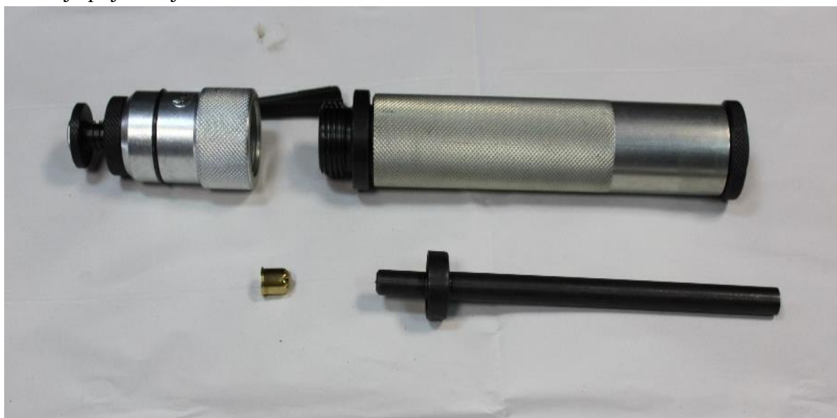
Slika 1 – Pištolj za omamljivanje stoke
