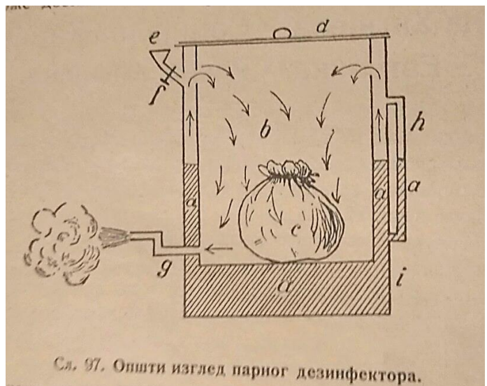
Slika 5.17 Improvizacija aparata za dezinfekciju
