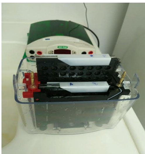
Slika 4. Prikaz uranjanja složene kazete u posudu za prijenos
