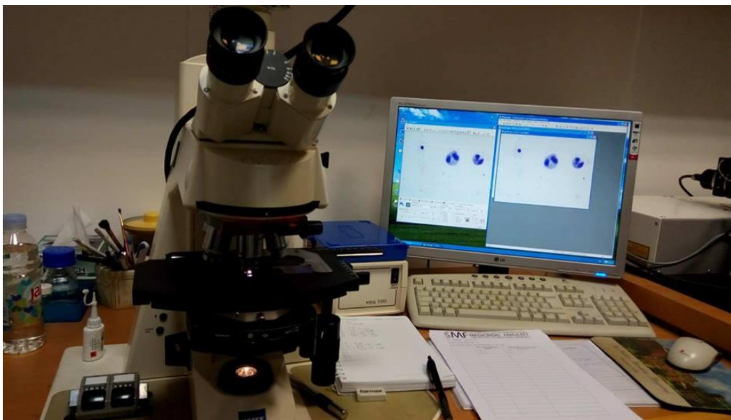
Slika 4. Svjetlosni mikroskop Axioskop 2 MOT Zeiss za analizu preparata
