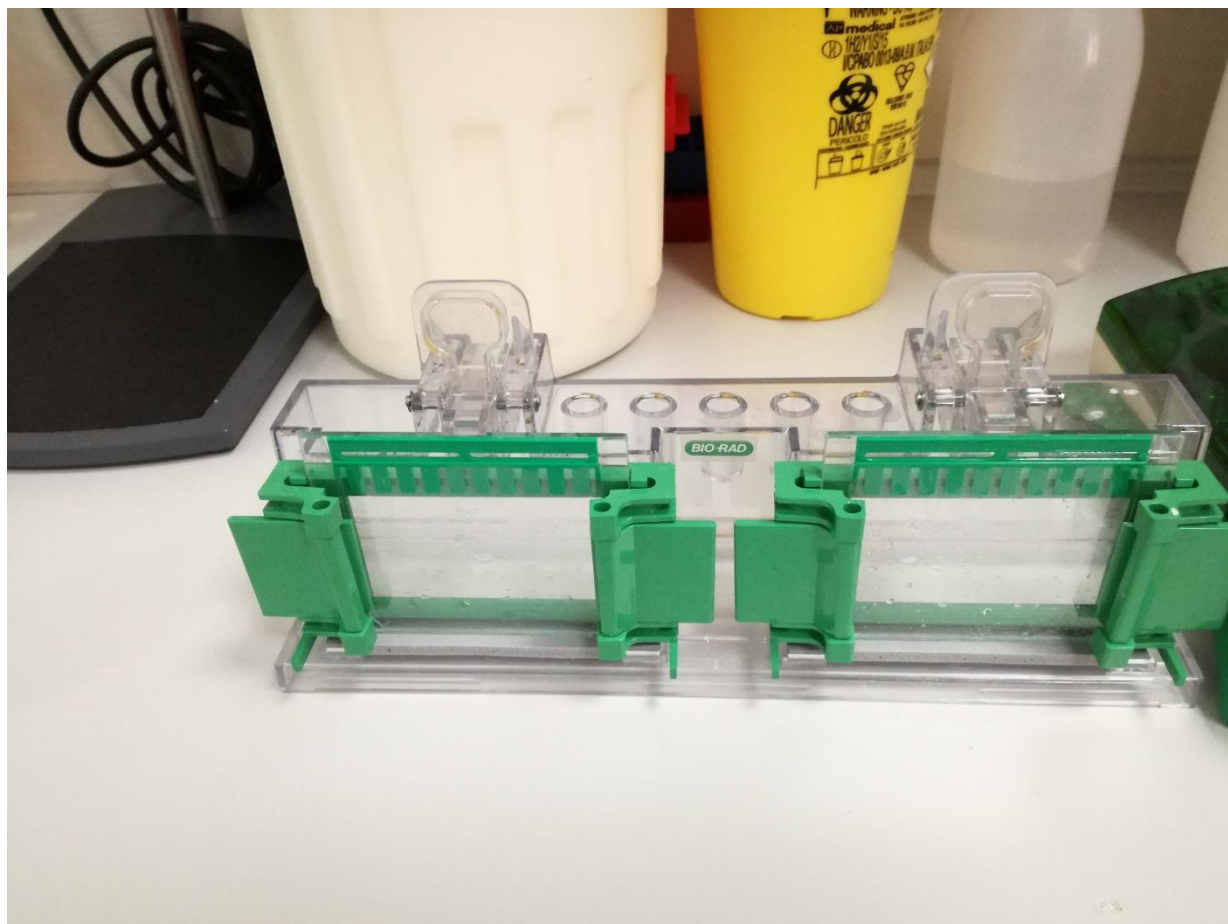
Slika 5. Postavljanje sustava za polimeriziranje gelova za elektroforezu
