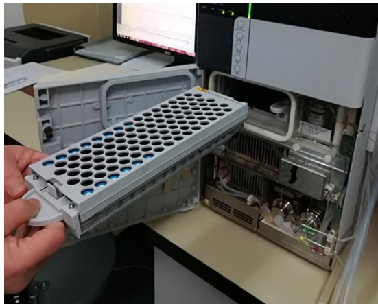
Slika 5: Ulaganje nosača uzoraka u autoinjektor uređaja LC-MS/MS
